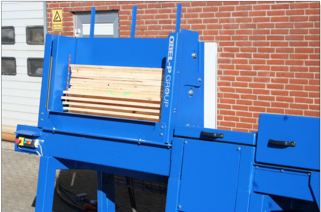
Casier pour l'introduction de planches. Au pied, la chaîne alimentaire équipée de porteurs métalliques
