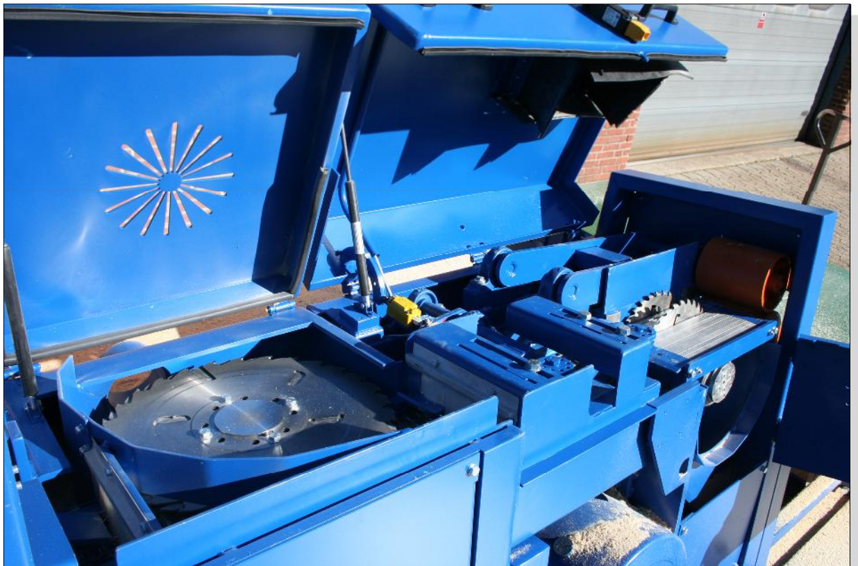
Links die StickApp Plus mit horizontaler Sägebüchse für die Reduzierung der Brett- & Lattenstärke
